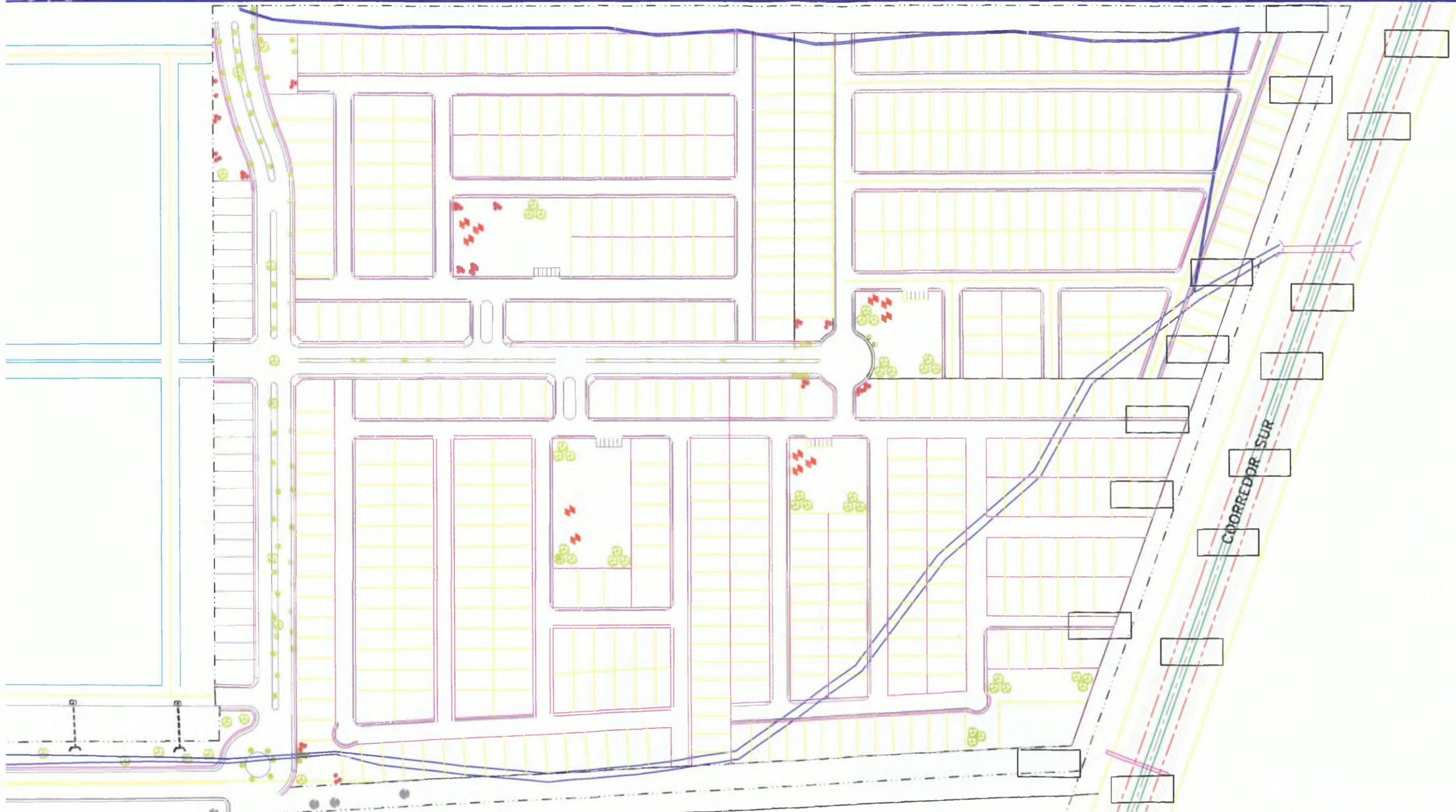
**La figura No 12:** Elevaciones en los extremos de las calles 32A y 32B de la Urbanización Altos de las Acacias, también se muestran las elevaciones en la superficie de rodadura del Corredor Sur, dentro del tramo de la cuenca.
