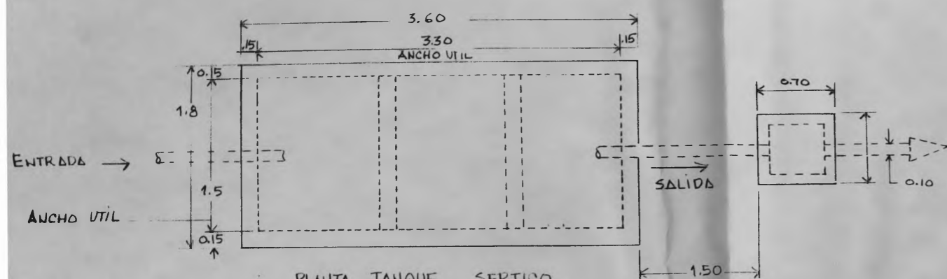
PLANTA TANQUE SEPTICO
