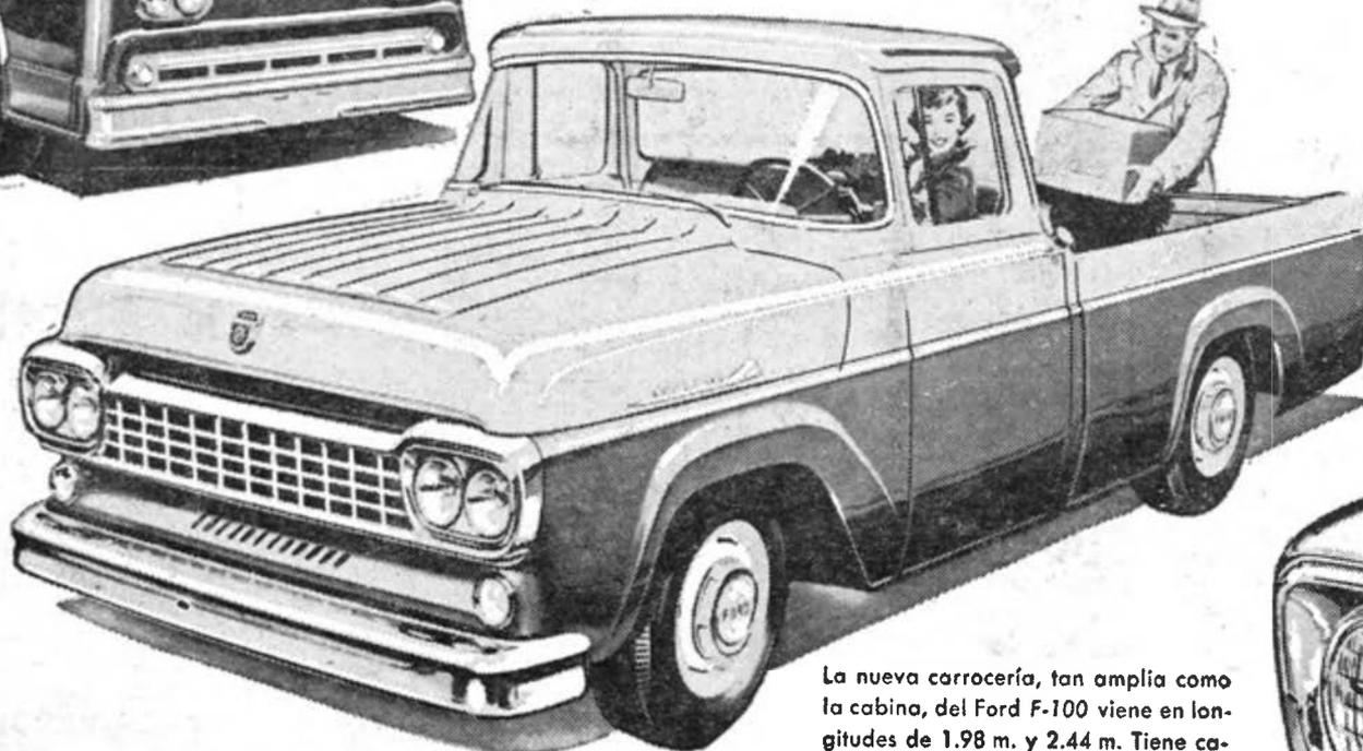
La nueva carrocería, tan amplia como la cabina, del Ford F-100 viene en longitudes de 1.98 m. y 2.44 m. Tiene capacidad hasta de 2 metros cúbicos y resiste un peso máximo PBV de 2268 kilos.
